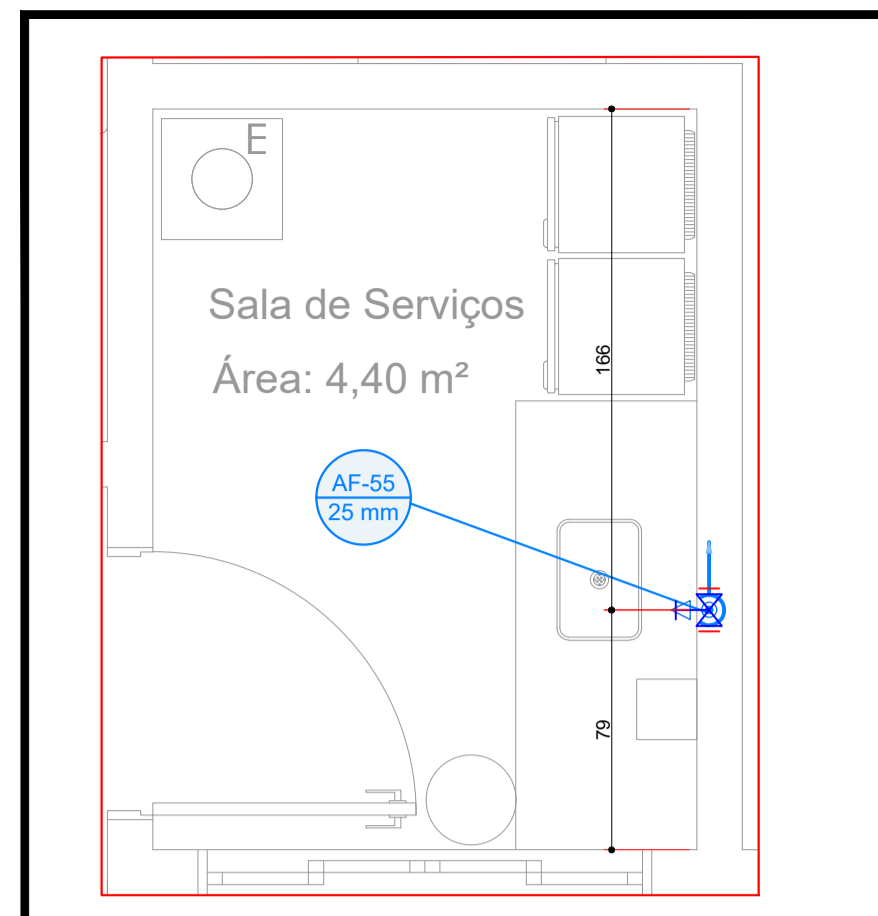
1 Esc. ESQUEMA DE INSTALAÇÕES DE ÁGUA FRIA AF-13 1:25 DETALHE H50 - PLANTA BAIXA
