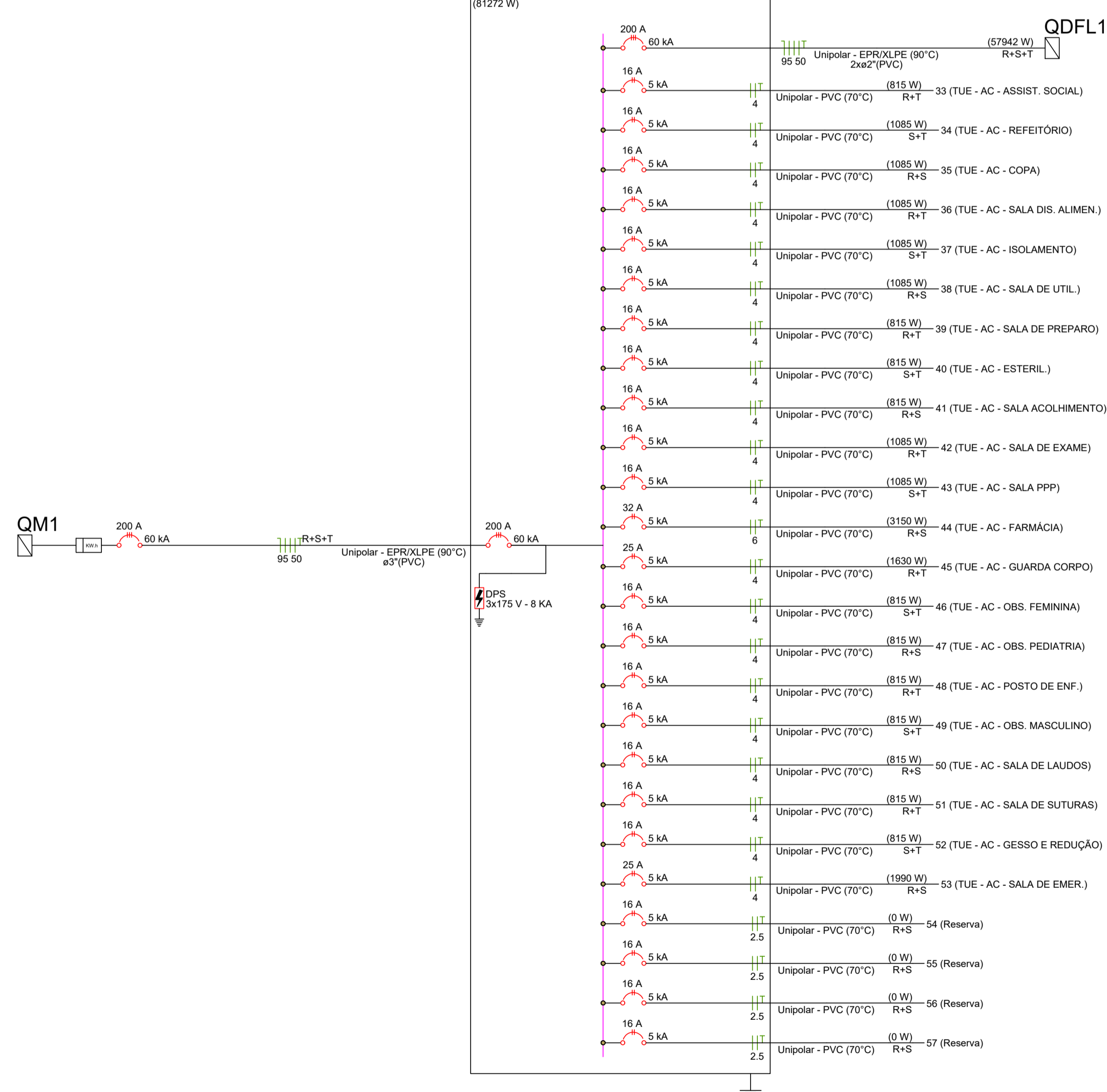
QDBT1 (Quadro de Distribuição de Baixa Tensão)
